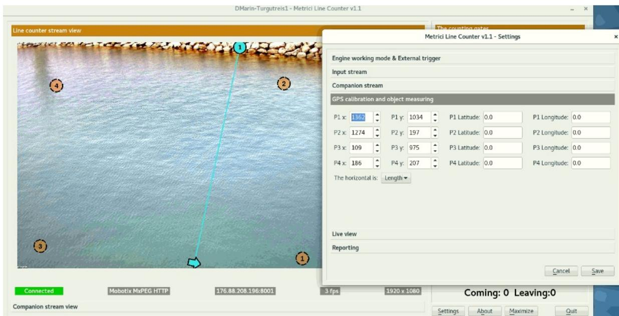
Pentru fiecare punct veti avea nevoie de latitudine si longitudine. X si y sunt coordonatele punctelor pe imagine. Dupa calibrare, Metrici va masura cat de mare este un obiect. Retineti ca punctele plasate pe imagine ar trebui sa corespunda "la milimetru" cu masuratorile GPS din teren pentru un calcul cat mai exact.
