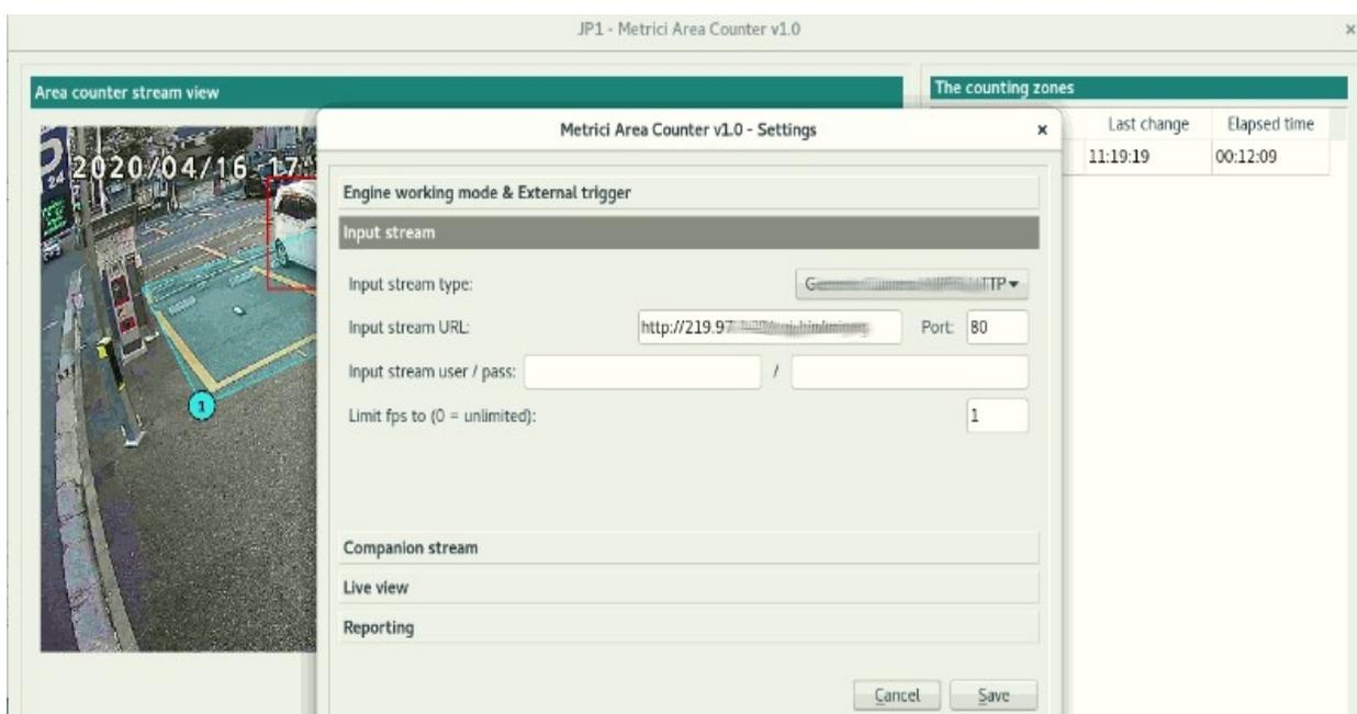
Secțiunea **Input stream** va fi completată cu datele de conectare la camera: IP, user și parola, precum în exemplu alăturat.
