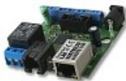
Lan controller-ul cu PoE de la ATS poate fi folosit in combinatie cu Metrici LPR, pentru a deschide bariera atunci cand un numar de inmatriculara aflat in 'Actions list' este recunoscut.
